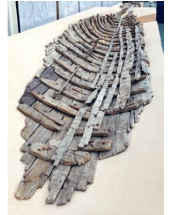
Spätantike Patrouillenboote (Wrack 1 und 5) aus dem Rhein bei Mainz im Museum für Antike Schifffahrt in Mainz. Solche Boote vom Typ Lusoria sind einst auch auf der Donau und ihren Nebenflüssen gefahren. Diese dienen als Vorbilder für den Bau der Danuvina Alacris. (Fotos: FAU, Boris Dreyer)
