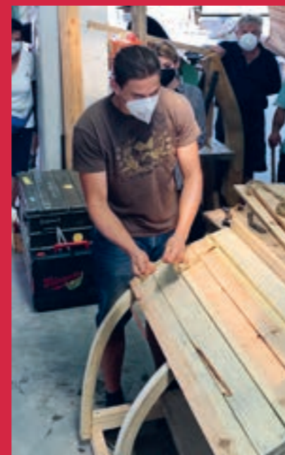
Sämtliche Arbeitsschritte erfolgten unter „römischen Bedingungen“: Abdichten der Planken mit Hanf (Foto: Mathias Orgeldinger)
