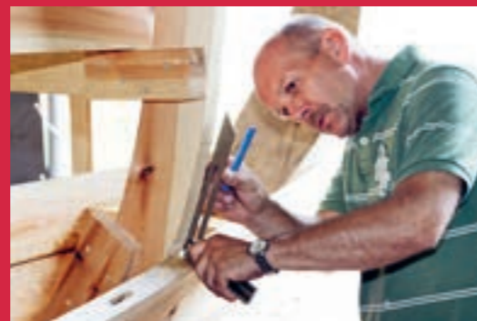
Für den Bau der F.A.N. 2018 wurden, wie beim Original, Eiche und Kiefer verwendet. Rekonstruktion der historischen Riemenaufhängung (Fotos: Mathias Orgeldinger)
